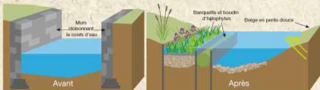
Principe de restauration écologique de berges
